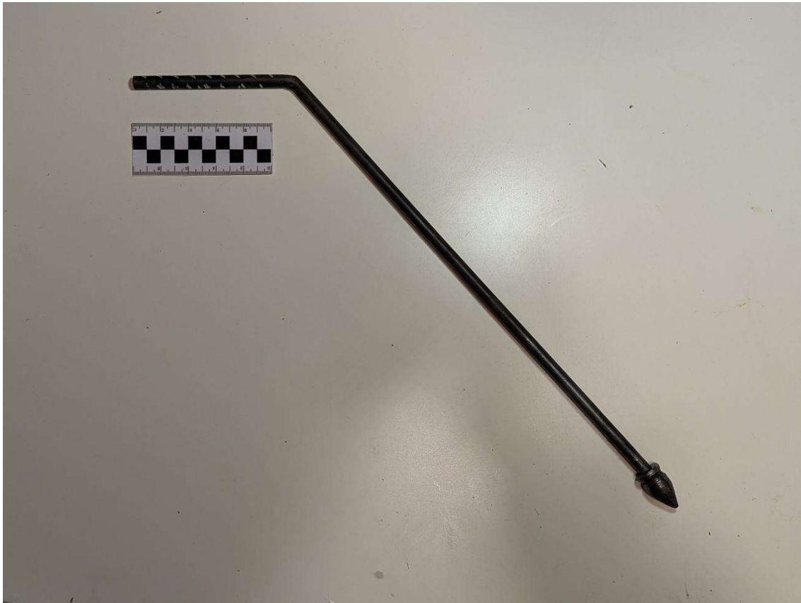
Figura 1. Gnomon realizado por Elías de Andrés con las medidas solicitadas en proyecto y realizado en acero inoxidable.
